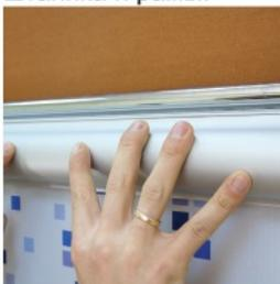
6. Выровнять по меткам нижнюю часть карниза и прижать его к плоскости рамы.
