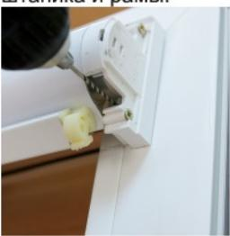
7. Сверлом диаметром 2 мм высверлить отверстия под саморезы.
